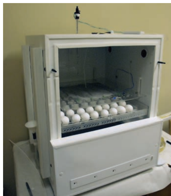
Рис. 3. Общий вид инкубатора, использованного в эксперименте с эмбрионами (Григорьев Ю.Г., 2003)
